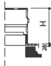
Base Alta Flange de fixação com isolamento 20mm
